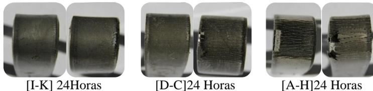
**Figura 7.** Probetas Ensayo de Doblado después de la exposición.
