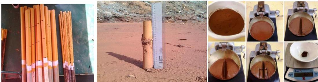
**Figuras: 3a. Elementos (cabillas calibradas) para medición de pérdidas y ganancias de suelos en la parcela experimental, 3b. Proceso de medición en sitio. 3c. Prueba de laboratorio de Casagrande para determinación de plasticidad en fracciones arcillosas de los suelos en CVM-S.A., División Níquel.**
