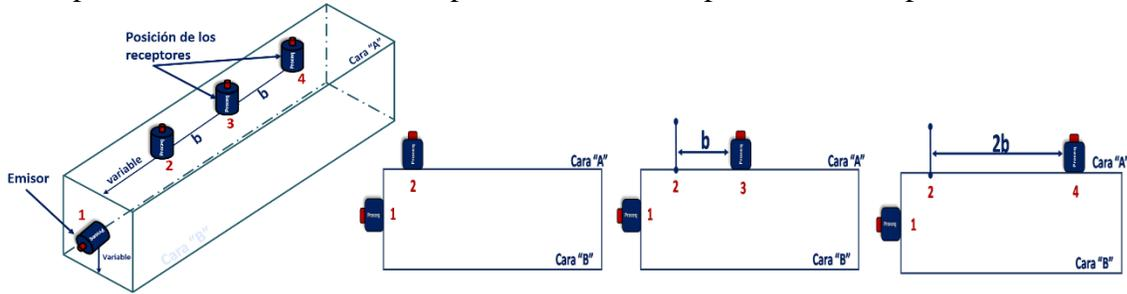
Figura 3. Colocación de los transductores - Método Semidirecto.
