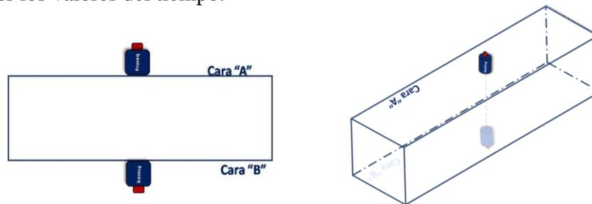
Figura 1. Colocación de los transductores.- método directo.
