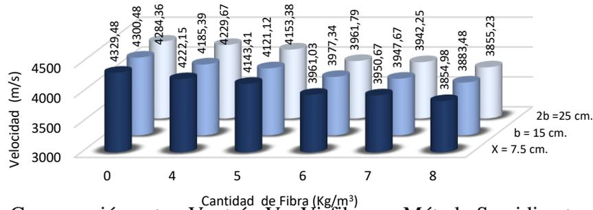
Figura 6. Comparación entre  $V_{patrón}$  Vs.  $V_i$ -fibras, - Método Semidirecto con variación en la separación (viguetas)
