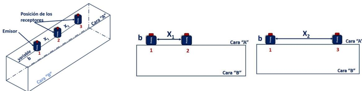
Figura 2. Colocación de los transductores -Método Indirecto.
