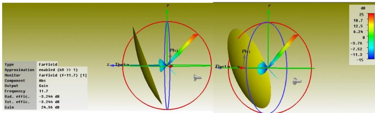
**Figura 4:** Patrón de radiación del conjunto bocina y reflector (11,7 GHz).
