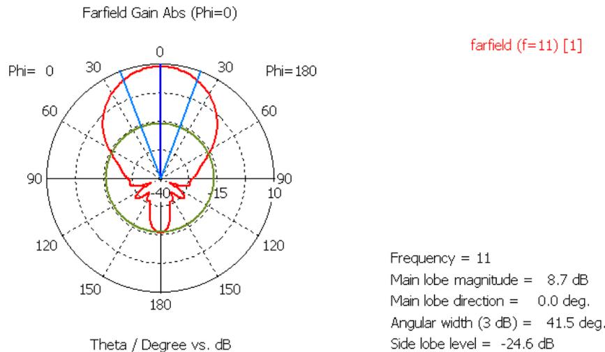
**Figura 5:** Patrón de radiación en plano polar (11GHz).
