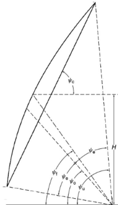
**Figura 1:** Parámetros de un Reflector offset. [2]
