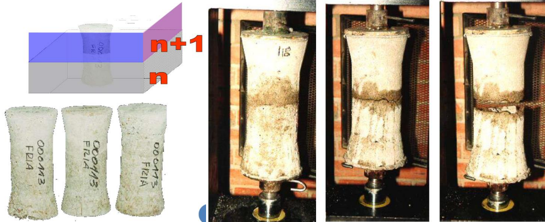
Figuras 5 y 6. Toma de muestras para ensayo de corte directo, muestras ensayadas [2]
