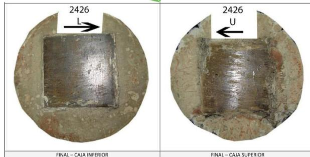
**Figura 4. Condición final de las muestras, vez concluido el ensayo en la parte inferior se observa el revestidor y en la parte superior el cemento, con ambas superficies totalmente pulidas. Las flechas indican la dirección del movimiento de corte [6]**
