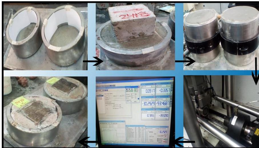
**Figura 3. Esquema simplificado en imágenes del ensayo de corte [6]**
