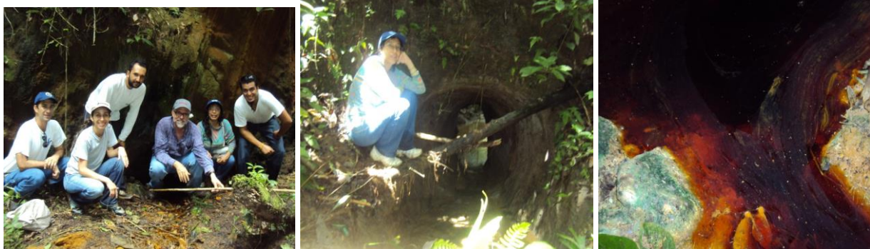
Figuras 3a, 3b y 3c. Fotografías del equipo de trabajo en el portal del socavón en el río Buría; foto frente al túnel de trasvase de agua y foto del drenaje ácido de mina, por presencia de minerales sulfurosos.
