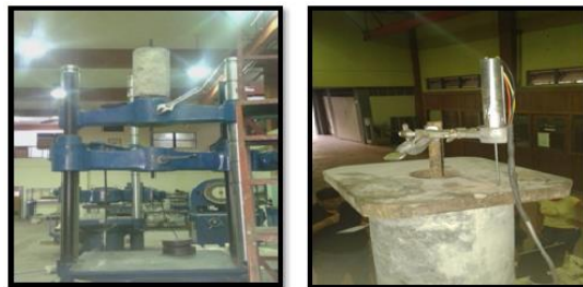
Figura 4. Colocación del LVDT
